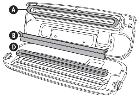
Irrota käskäytöisen pakkauslaitteen nestesäiliö jokaisen käyttökerran jälkeen. Pese se lämpimällä saippuavedellä ja anna kuivua huoneenlämmössä ennen paikoilleen asettamista.
