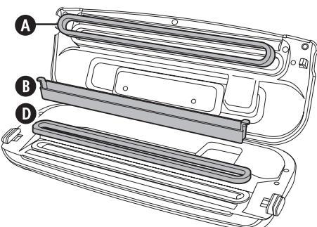
Extraiga el depósito del sellador de mano después de cada uso. Lávelo con agua caliente jabonosa y déjelo secar por completo al aire antes de volver a colocarlo.
