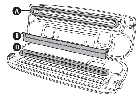
Αφαιρέστε το δοχείο της συσκευής σφράγισης χειρός μετά από κάθε χρήση. Πλύντε το σε ζεστό νερό με σαπουνάδα και αφήστε το να στεγνώσει καλά πριν τον επανατοποθετήσετε.
