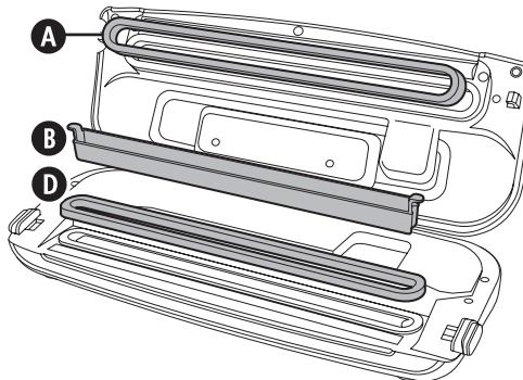
Após cada utilização, retire o depósito do equipamento de selagem manual. Lave em água morna e detergente e deixe secar bem ao ar antes de voltar a colocar.
