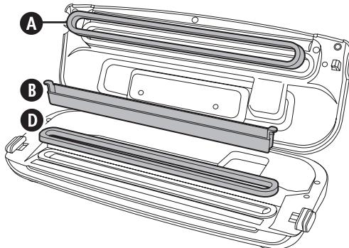
Togliere il serbatoio della sigillatrice portatile dopo ciascun utilizzo. Lavare in acqua saponata tiepida e far asciugare completamente prima di reinserirlo.
